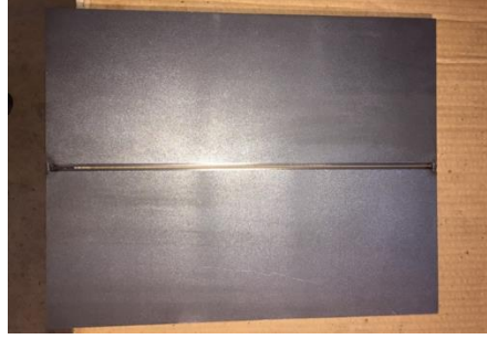
Şekil 2: EN ISO 15614'e göre hazırlanmış N1 kodlu numune gösterilmektedir.
