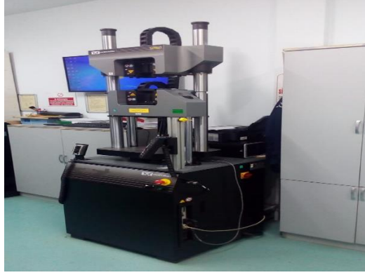
ŞEKİL 3: 'INSTRON 300DX' ÇEKME TESTİ CİHAZI GÖSTERİLMİŞTİR.
