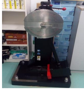
ŞEKİL 11: INSTRON IMPACT SI-1K3 ÇENTİK DARBE TEST CİHAZI GÖSTERİLMEKTEDİR.
